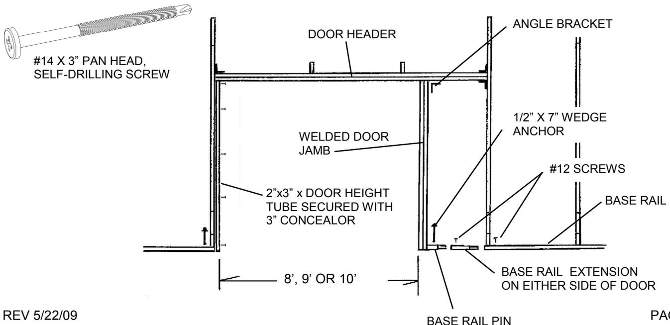
**STEP 6: ASSEMBLING THE SPECIAL ROOF/WALL FRAME SECTION FOR SIDE DOORS.**
